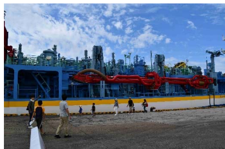
赤い部分が水底の土砂を吸い込むホース部 分です。近くで見るとほんとに大きい！！
